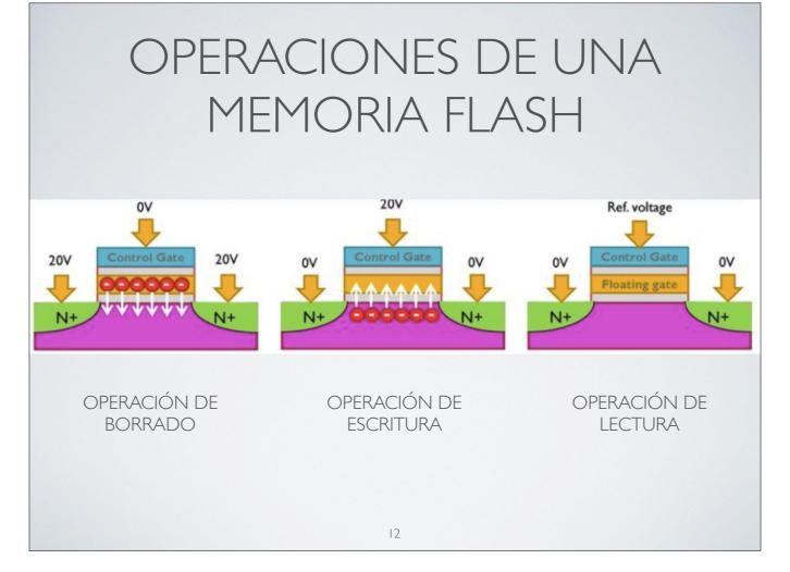
El proceso de borrado se basa en la tunelación FN que consiste en aplicar un alto voltaje al substrato que hace que los electrones salgan de la puerta flotante -> 1 lógico
